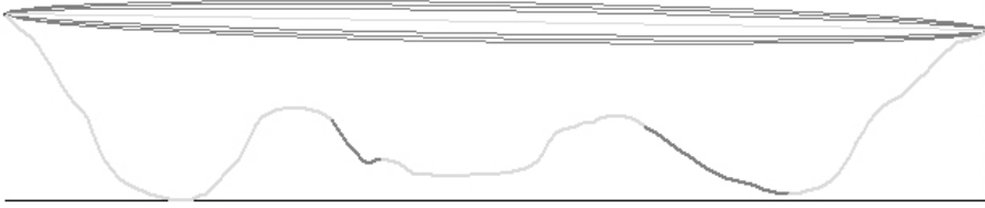
شكل 3.20: جدوى الوصلة، وتظهر على الشكل أيضاً منطقة فرانيل الأولى وتخمين خط النظر باستخدام برنامج RadioMobile.
