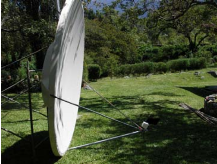
شكل 11.29: طبق عاكس بقطر 2.4 متر يحتوي على هوائي ربحه 12 ديسيبل أيزوتروبي dB i مركب في المحرق. يميل الطبق إلى الأسفل بزواوية قدرها 14 درجة.
