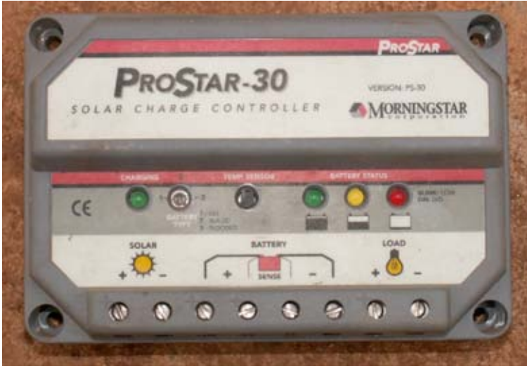
شكل 7.3: منظم لشحن الطاقة الشمسية باستطاعة 30 أمبير.
