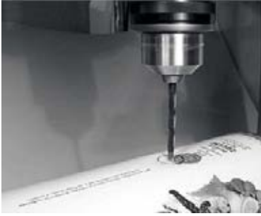
شكل 4.36: إحفر الثقب بعناية وبتدرج حتى تحصل على حجم الفتحة المطلوب.
