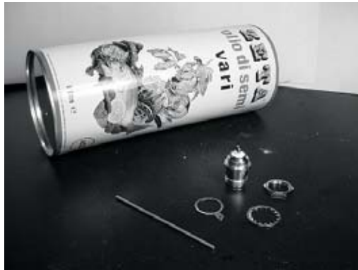
شكل 3: أجزاء هوائي العلب المعدنية.
