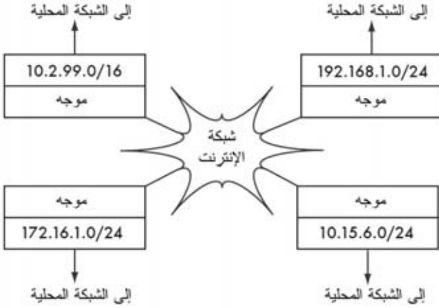
شكل 3.5: يمكن استخدام عناوين الإنترنت الخاصة المحددة ضمن الوثيقة RFC1918 داخل المؤسسة ولا يمكن توجيهها عبر شبكة الإنترنت.
