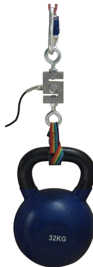
Figura 5.48: Calibración del sensor de fuerza
